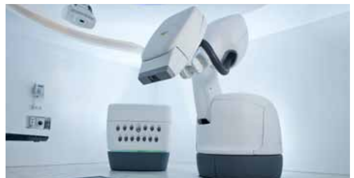
Abb. 1: Das Cyberknife M6, ein robotergestützter Linearbeschleuniger
